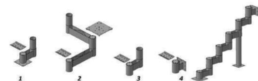
2. Төменгі элемент (№ 1) әрдайым бірінші болып жүреді. Оның ерекшелігі - элементті төменгі қабаттың еденіне металл тақтайша бекітіп қоюға мүмкіндік береді. Төменгі элементке, баспалдақтың конфигурациясына байланысты, аралық және қажет болған жағдайда бұрыш элементтері бекітіледі.
