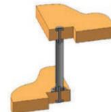
Болты устанавливают по краям ступеней и стягивают болтами М8х50 с шайбой снизу и мебельным с широкой шляпкой М8х60 сверху. Собирают болц сверху, установив мебельный болт, затем навинтив на него болц и стянув конструкцию болтом снизу.
