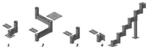
2. Первым всегда идет нижний элемент (№ 1). Его особенностью является металлическая пластина, позволяющая надежно закрепить элемент к полу нижнего этажа. К нижнему элементу, в зависимости от конфигурации лестницы, крепятся промежуточные и, при необходимости, угловые элементы.
